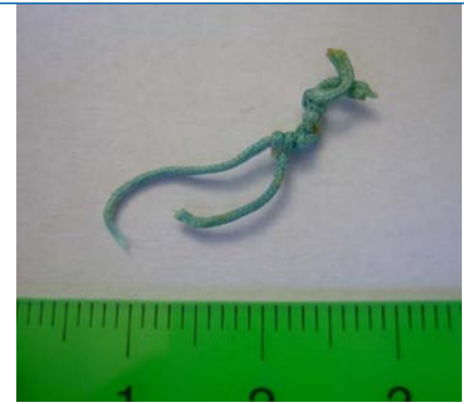
Abb. 4 ▲ An der Ankeröse durchgeschauerter Ethibond-3-Faden
